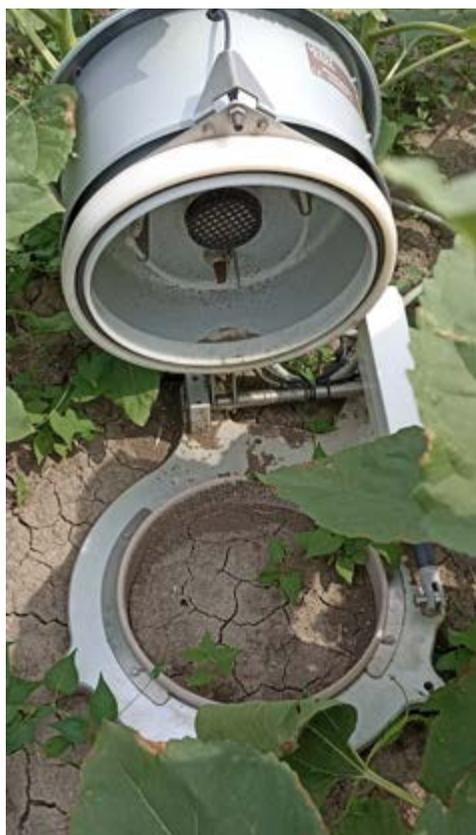
Camera di accumulo per la rilevazione e misurazione delle emissioni dei gas serra dal suolo
